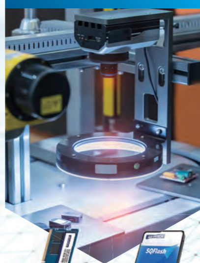
AOI検査マシン
